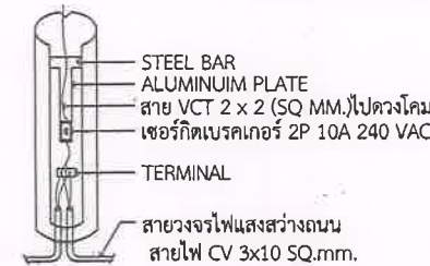
รายละเอียดการต่อสายภายในเสา
